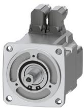
SIMOTICS S-1FK2 HD servo motor M0=16 Nm; PN = 3,3 kW a nN=3000 rpm (380-480 V); PN = 2,15 kW a nN=1500 rpm (200-240 V); grau de proteção IP65; eixo D24x50 mm com chave de pena; codificador absoluto de 22 bits + multivolta de 12 bits (codificador AM22DQC); com plugue DRIVE-CLiQ M17; conector de alimentação tamanho M23;
