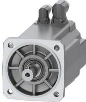
SIMOTICS S-1FK2 CT servo motor M0=12 Nm; PN = 2,85 kW a nN=3000 rpm (380-480 V); PN = 1,72 kW a nN=1500 rpm (200-240 V); grau de proteção IP65; eixo D24x50 mm com chave de pena; codificador absoluto de 22 bits + multivolta de 12 bits (codificador AM22DQC); com plugue DRIVE-CLiQ M17; conector de alimentação tamanho M23;
