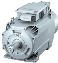
motor principal para SINAMICS S120; 3 tensão de funcionamento 380 V 3AC Pn=15 kW; Nn=1000 rpm Mn=143 Nm altura do eixo 132 mm IC22DQ eixo com chave de pena, balanceamento de meia chave ventilação forçada, direção do fluxo de ar D IP55 compatível com conversores SI Severidade de vibração Extensão do eixo S e precisão de flange potência e porta de sinal
