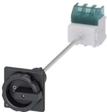
SENTRON, seccionador de corte em carga 3LD, interruptor principal, de 3 polos, Iu: 63 A, potência de operação/ a CA-23 A a 400V: 22 kW, fixação no piso com acoplamento da porta, acionamento rotativo, preto, fixação central 22,5mm para o manípulo
