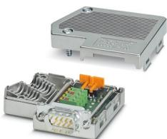
Conector D-SUB, 9 polos, pino, duas entradas de cabos com ângulo de 35°, sistema de bus: PROFIBUS DP até 12 MBit/s, resistor de terminação comutável via comutador deslizante, alocação de pinos: 3, 5, 6, 8; terminais de conexão por força de mola
