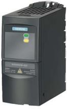
**\*\*peça de reposição\*\* MICROMASTER 420 sem filtro 200-240 V 1/3 AC+10/-10% 47-63 Hz torque constante 0,75 kW sobrecarga 150% para 60 s torque de lei quadrada 0,75 kW 173x 73x 149 (AxLxP) grau de proteção IP20 temperatura ambiente -10+50 °C sem AOP/BOP**
