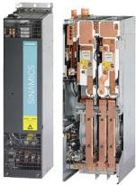
Entrada do módulo de motor único SINAMICS S120: 510 - 720 V DC saída: 380 - 480 V 3AC, 310 A potência nominal: 160 kW tipo de construção: suporte de refrigeração líquida integrado integrado das funções integradas de segurança estendidas
