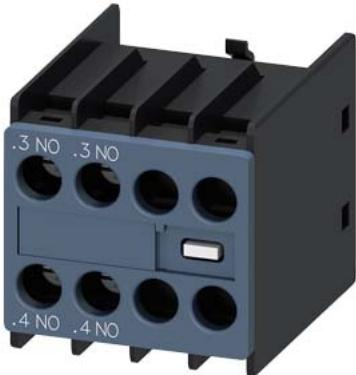
auxiliary switch, on the front, 2 NO, .3/.4, .3/.4, --/--, --/--, current path: 1 NO, 1 NO, --, --, screw terminal, for contactors 3RT2 and contactor relays 3RH2
