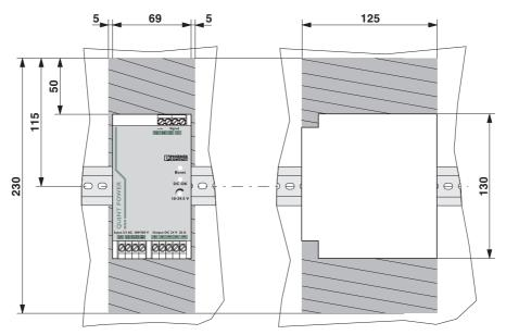
Posición de montaje estrecha: Profundidad de montaje 125 mm (+ carril) (estado de suministro)
