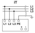
La conexión para 3 x 400 V AC ... 500 V AC se efectúa a través de las conexiones por tornillo L1, L2, L3 y PE. El aparato puede conectarse a sistemas de corriente trifásica con unas tensiones nominales de 3 x 400 V AC ... 500 V AC. El servicio permanente a potencia nominal está garantizado en caso de fallo de una fase.
