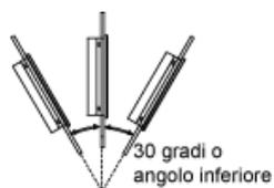
Ao instalar o painel na posição inclinada com inclinação superior a 30°, a temperatura ambiente não deverá exceder 40°C (104°F). Pode ser necessário usar resfriamento com ar forçado (ventilador, A/C) para garantir que a temperatura ambiente de funcionamento seja 40°C (104°F) ou inferior.
