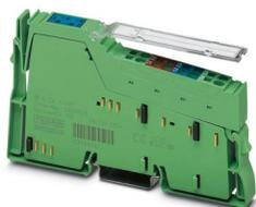
Inline, Terminal de entrada digital, Entradas digitais: 4, 24 V DC, tecnologia de conexão: 3 condutores, velocidade de transmissão no bus local: 500 kBit/s, grau de proteção: IP20, inclusive conector Inline e campo de identificação
