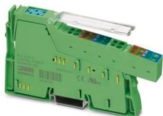
Inline, Terminal de entrada digital, Entradas digitais: 4, 24 V DC, tecnologia de conexão: 3 condutores, velocidade de transmissão no bus local: 500 kBit/s, grau de proteção: IP20, inclusive conector Inline e campo de identificação
