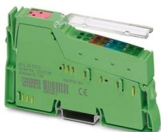
Inline, Terminal de saída digital, Saídas digitais: 2, 24 V DC, tecnologia de conexão: 4 condutores, velocidade de transmissão no bus local: 500 kBit/s, grau de proteção: IP20, inclusive conector Inline e campo de identificação
