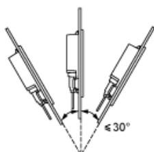
Ao instalar o painel em uma posição inclinada, e a face do painel inclinar mais de  $30^\circ$ , a temperatura ambiente não deve exceder  $40^\circ\text{C}$  ( $104^\circ\text{F}$ ).
