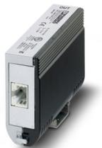
Proteção contra surtos de tensão conf. classe E<sub>A</sub> (CAT6<sub>A</sub>), para Gigabit Ethernet (até 10 GBit/s), Token Ring, FDDI/CDDI, ISDN, DS1. Adequado para Power over Ethernet (PoE++ / 4PPoE) "Modo A" e "Modo B". Conector intermediário RJ45 com cabo de ligação à terra separado e com base de encaixe para ligação à terra para trilhos de fixação NS 35.
