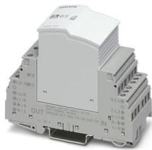
Proteção de equipamentos plugável, conforme tipo 3/classe III, para redes de fornecimento de energia trifásicas com N e PE separados (sistema de 5 condutores: L1, L2, L3, N, PE), com fusível à prova de corrente de surto integrado e contato de sinalização remota.
